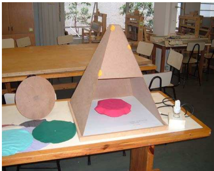
Figuras 6.79 y 6.80 - Equipo para medición de “Índice de Caída” en telas
