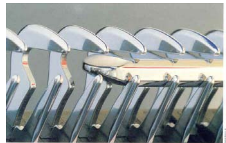
Fig. 6.43 y 6.44 - PROYECTILES VIAJANDO EN LA CALADA
