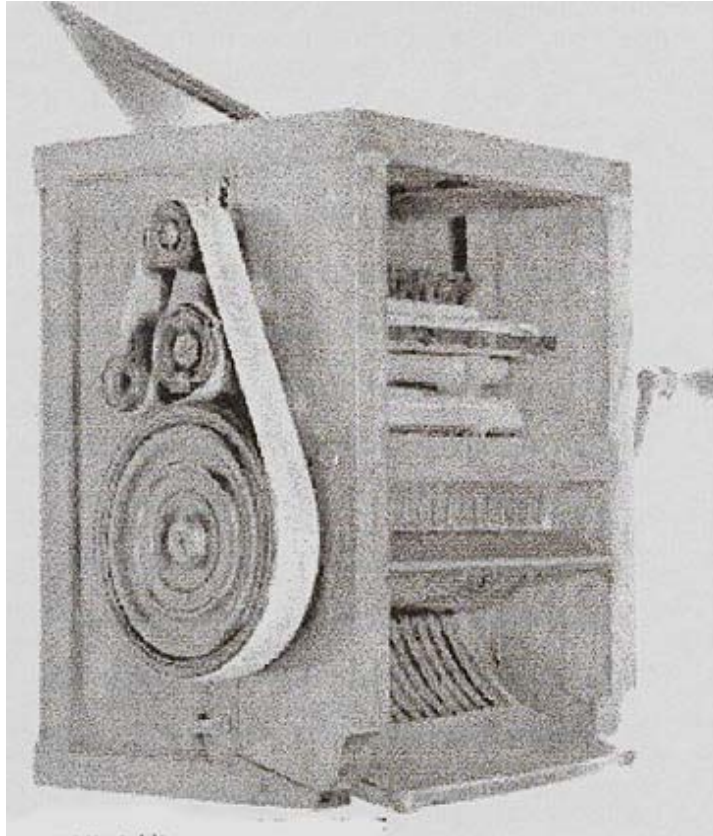
Figura 1.67 - Antigua desmotadora de algodón de Eli Whitney
