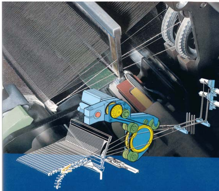
Figura 6.48 - MECANISMO TEJEDOR DEL ORILLO
