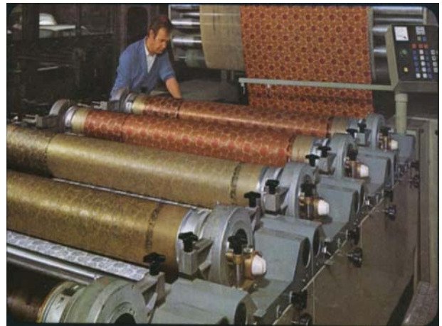
Figura 1.82 - Estampación rotativa en huecograbado
