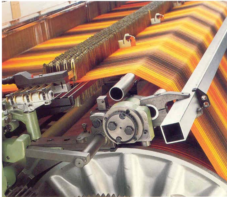
Figura 6.47 - MECANISMO TENSOR DE URDIMBRE Y LAMINILLAS MONTADAS EN LOS HILOS DE URDIMBRE
