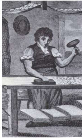
Fig. 9.5 - Estampación con bloques de madera
