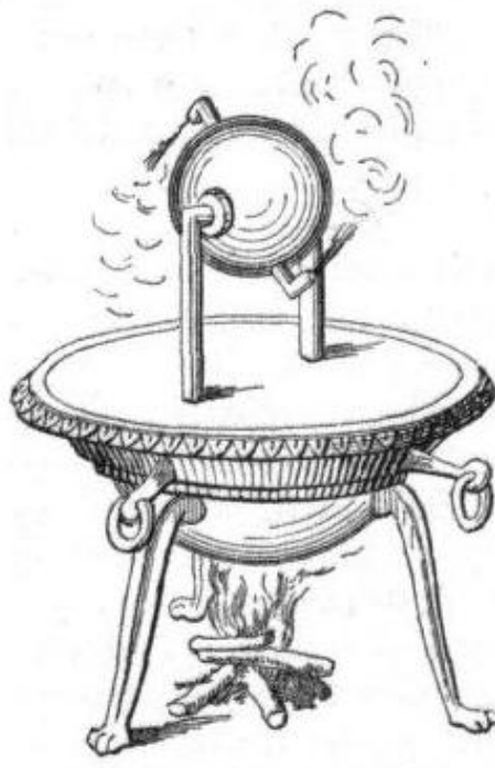
Figura 1. 94 - La Aeópila o Eópila de Herón de Alejandría
