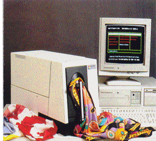
Figura 10.51 EQUIPO DE MEDICIÓN DE COLOR Espectrofotómetro de reflexión y computadora
