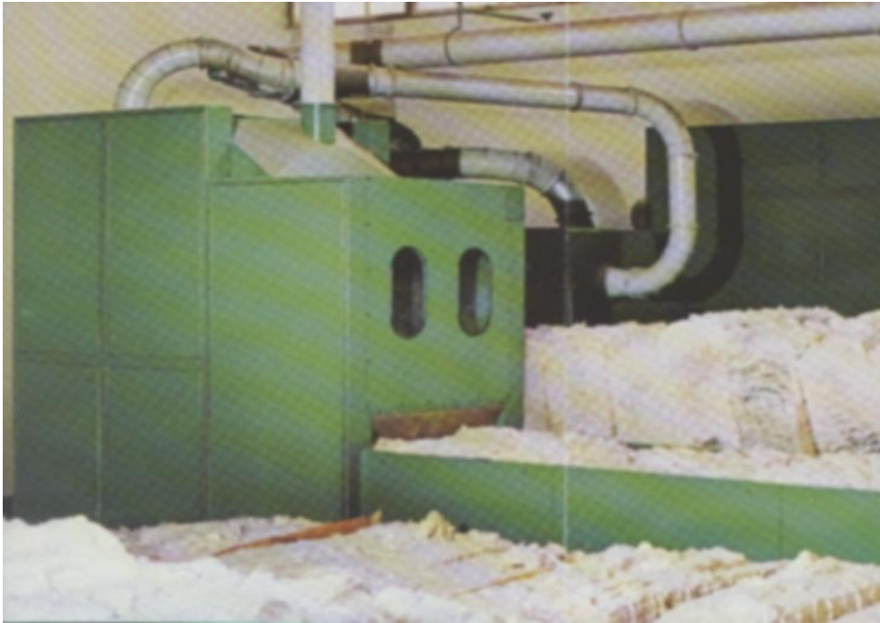
Figura 4.8 MÁQUINA ABRIDORA MEZCLADORA DE FARDOS Rieter Machine Works Ltd.
