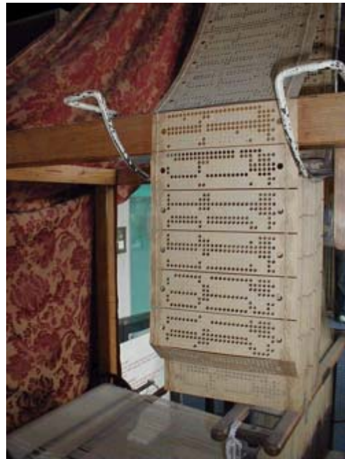
Figuras 6.33 y 6.34 - Tirantes y tarjetas perforadas de un telar Jacquard
