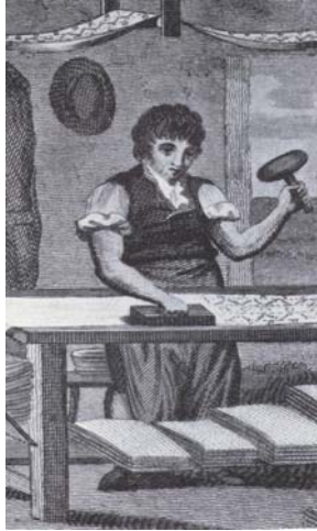
Figura 1.79 - Estampación con bloques de madera
