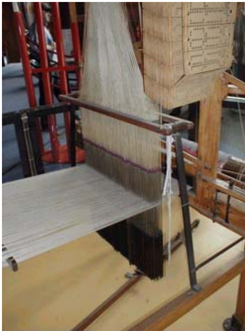
Figuras 6.33 y 6.34 - Tirantes y tarjetas perforadas de un telar Jacquard
