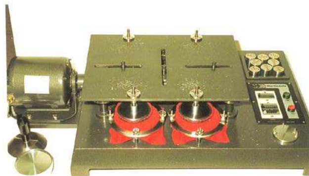
Figura 6.77- EQUIPO MARTINDALE PARA ENSAYO DE "PILLING" EN TELAS
