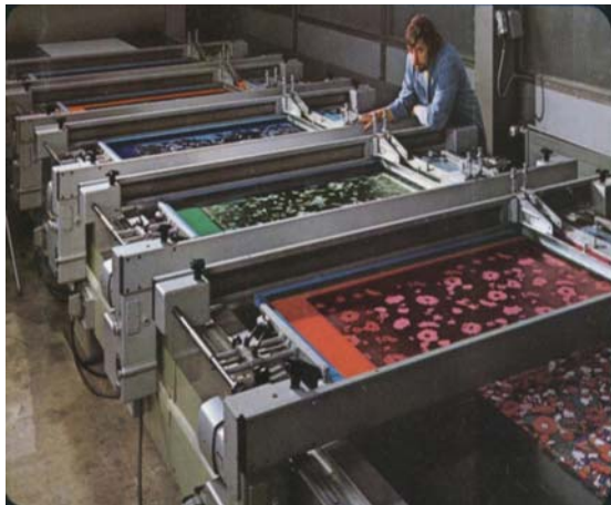
Fig. 9.7 - Estampación plana con "schablons"
