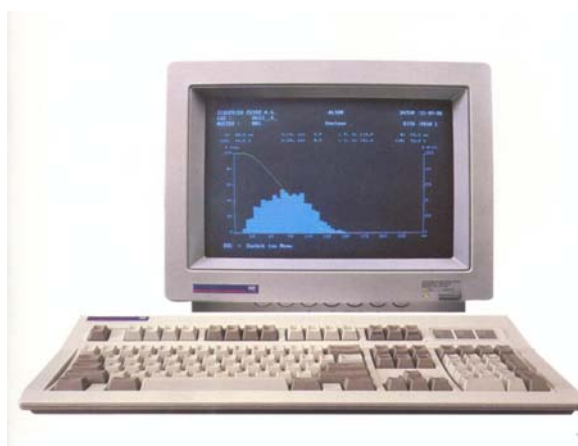
Figura 2.39 - Histograma y Diagrama acumulado en monitor de equipo Peyer
