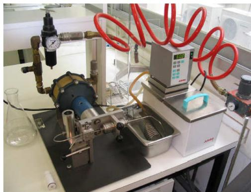
Fig. 1: Microfluidizer 110S con sistema de termostatación. Unidad de Biofísica, Universidad Autónoma de Barcelona, España.
