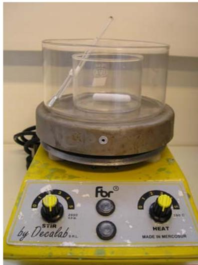
Figura 3-7. Dispositivo utilizado para realizar el tratamiento de grabado ácido
