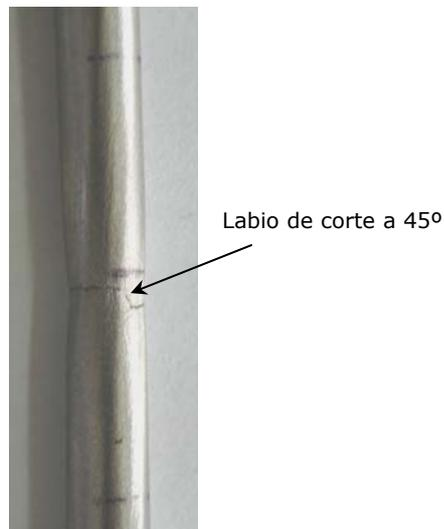
**Figura 4-2.** Probeta de tracción ensayada
