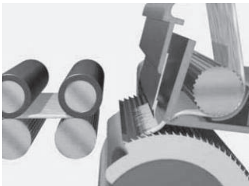
Esquema de un cabezal de peinado de algodón
