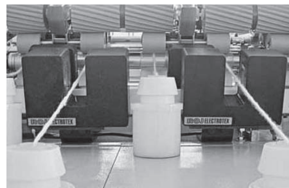
Mecha a la salida del tren de estiraje de la mechera
