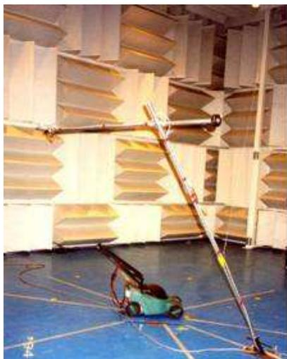
**Figura 10.** Medición de  $L_w$  en cámara semianecoica de una cortadora de césped según ISO 3475, método espiral. [10]
