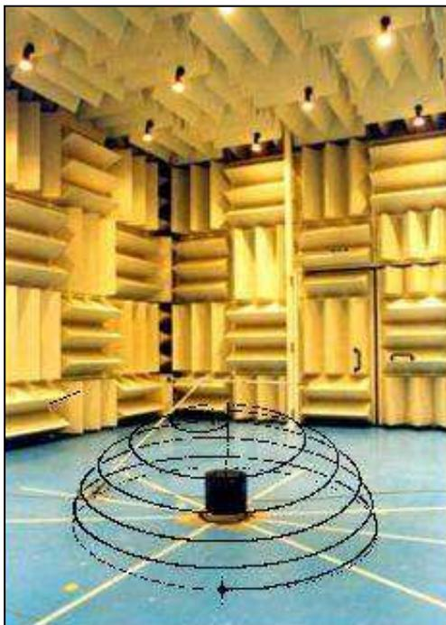
**Figura 7a.** Calibración de la FSR, B&K 4204, cámara semianecoica del INTI (método espiral)
