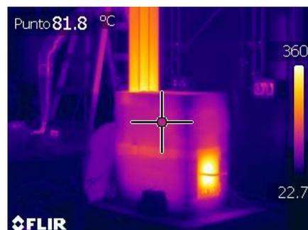
Figura 4: Termografía de la estufa QOÑI.
