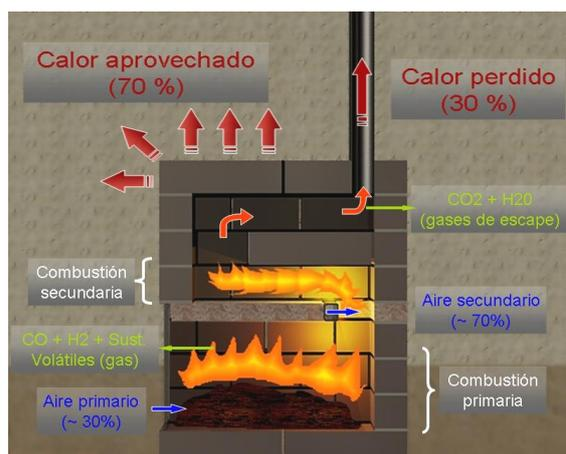
Figura 1: Funcionamiento de la estufa QOÑI
