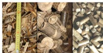
Figura 2: Chips (izq.) Briquetas (centro) Pellets (der.)
