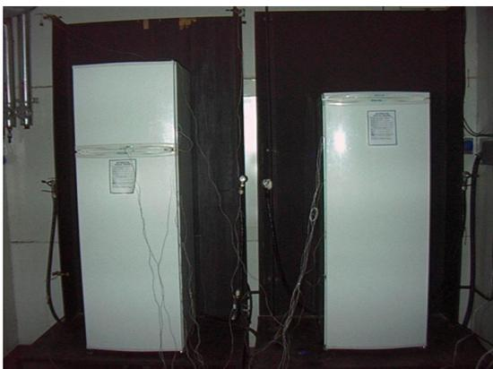
Fig.2: Refrigeradores ubicados sobre tarimas en un ensayo en el Laboratorio de Eficiencia Energética del CIPURE
